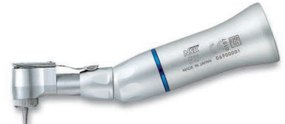
MODELE BB-EC REF. Y110-159 • Pour fraise CA (ø2,35) • Système baïonnette • Maxi. 40 000 t/mn-1
