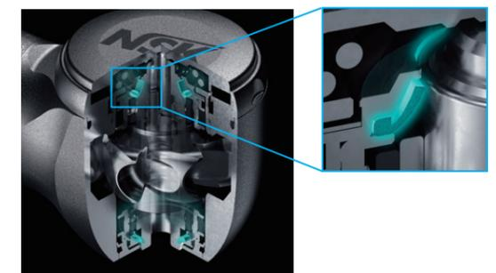
Lorsque l'alimentation en air est interrompue, le caoutchouc du frein entre en contact avec l'arbre en rotation pour appliquer un effet de freinage. Avec les freins fixés à l'avant et à l'arrière de la tête, le contact est accru, ce qui permet un arrêt quasi-instantané de la rotation.
